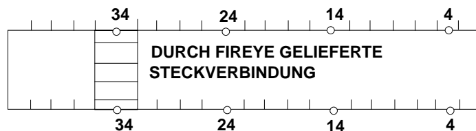
ABBILDUNG 5. HALBRACK -RÜCKANSICHT - SCHRAUBENPOSITIONEN DER STECKVERBINDUNGEN
