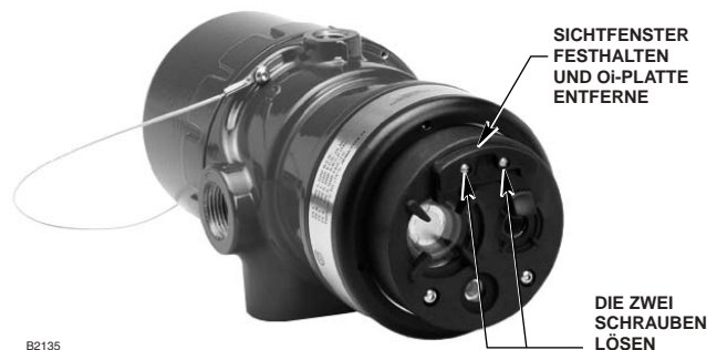
Abbildung 13—Entfernen der Oi-Platte
