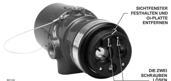
Abbildung 13—Entfernen der Oi-Platte
