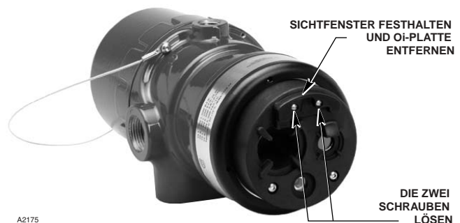
Abbildung 13—Entfernen der Oi-Platte
